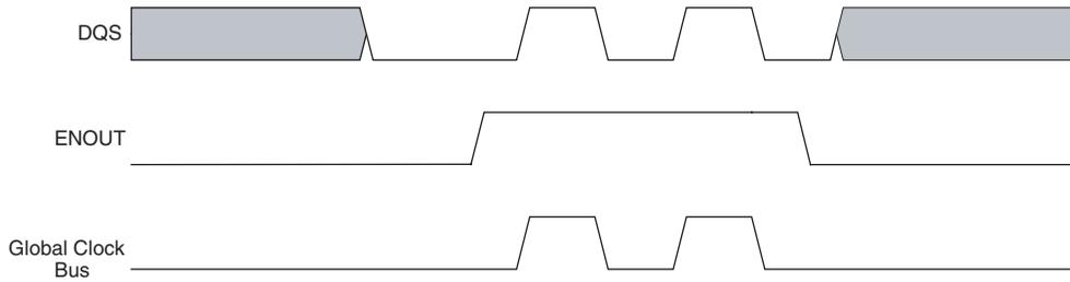
**Figure 9. Cyclone II DQS Postamble Circuitry Read Timing Waveform**
